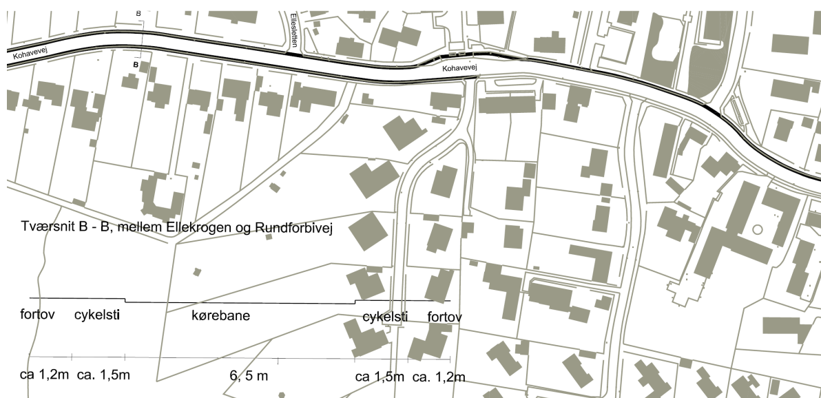
Figur 5. Kohavevej øst: Etablering af delt sti med samlet bredde på ca. 2,70 m. Stien tilsluttes eksisterende delt sti i vejens sydside ved Tuemosen.
